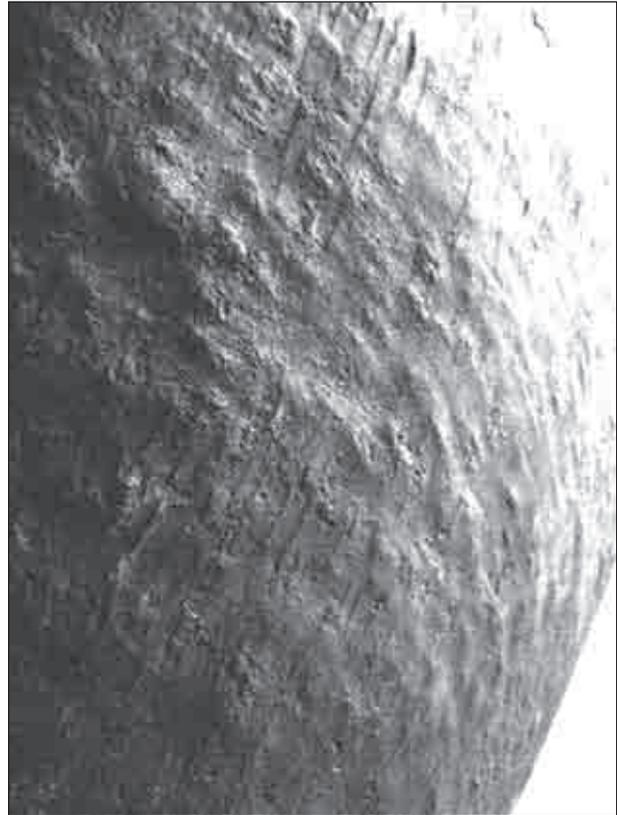
Рис. 5. Сліди кування на зовнішній поверхні
