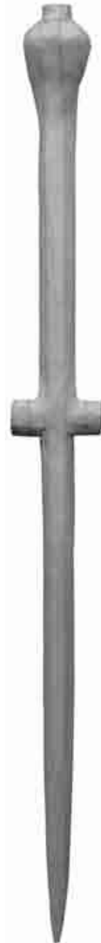
Рис. 8. Дерев'яний стрижень для експери- ментальної відливки
