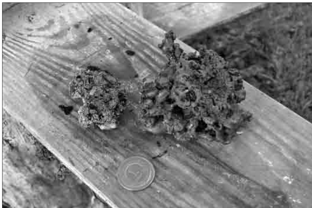
Ryc. 14. Amorficzny żużel kowalski powstały w wyniku operacji zgrzewania ogniowego. Fot. A. Wrona
