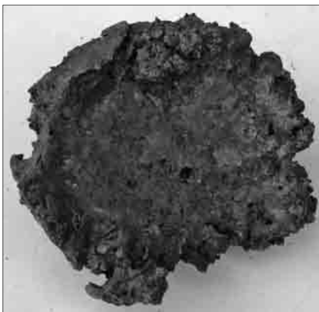
Ryc. 15. Żużel miseczkowy powstały w wyniku nawęglania żelaza tzw. «metodą Arystotelesa/Evenstad'a». Fot. A. Wrona
