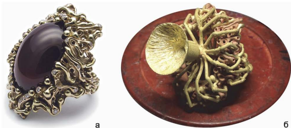
Рис. 2. а – каблучка "Hybrid casting #2: Carménère". Золото рожевого та жовтого кольору, дорогоцінне каміння. Подвійне литво. Віауріум; б – необроблена частина каблучки після подвійного литва. Віауріум
