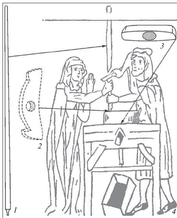
Рис. 6. Матеріали до реконструкції жорнових поставів: 1 — руків'я (шток); 2 — боковий підшипник; 3 — порплиця; 4 — мініатюра XIV ст. до польської легенди про св. Ядвігу (за: 1—3 — Колчин 1968, с. 76, 77; 4 — Довженко 1961, рис. 73)
