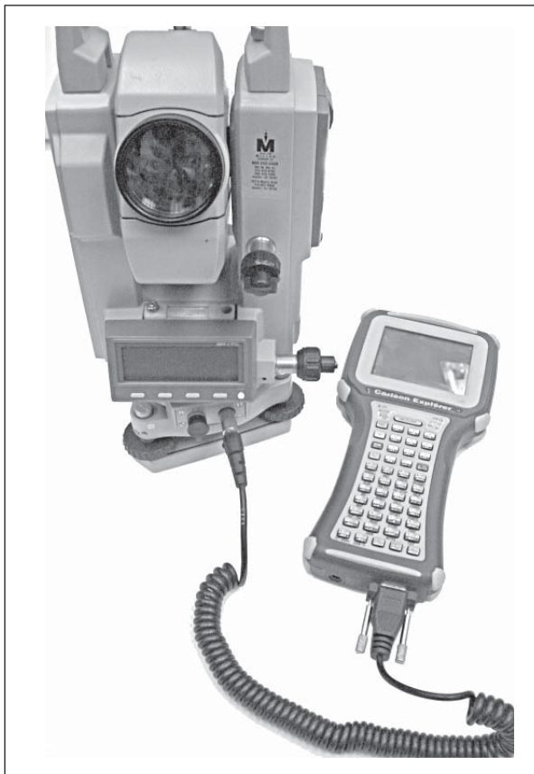
Рис. 3. Лазерний теодоліт Sokkia Set 5F і накопичувач даних Carlson Explorer
