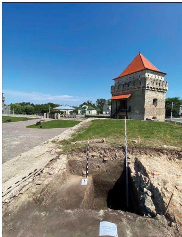
Рис. 2. Шурф визначення глибини залягання підосви капітальної стіни палацу у кв. Д/3
